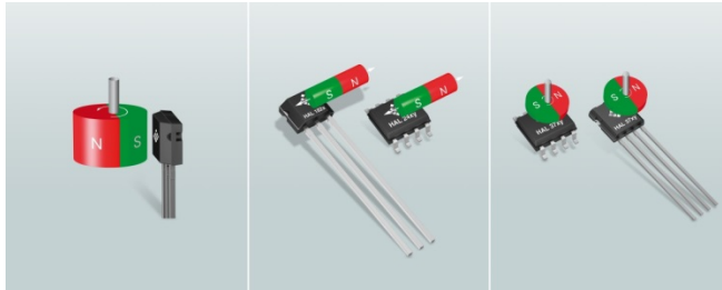
Micronas 霍尔传感器。从左至右：用于转速测量的霍尔开关，用于位置和运动测量的线性霍尔传感器，以及用于直接角度测量的二维霍尔传感器。
